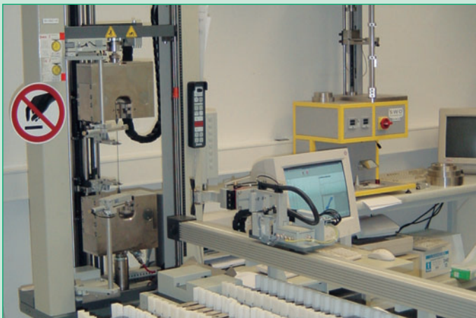
Fig. 7: Tensile test on Carbofol® geomembranes (ISO 527)
